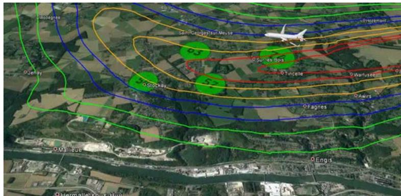
FIGURE 2.2: Capture d'écran de l'animation réalisée pour illustrer le décollage d'un avion à EBLG; le niveau de pression mesuré par 4 des sonomètres fixes (représentés par des disques verts) évolue en temps réel lors du passage de l'aéronef
